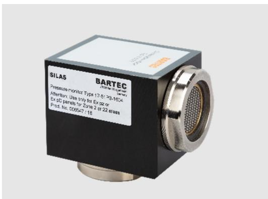
Der Druckwächter stellt zwei Funktionen innerhalb der Steuerung SILAS dar. Als erstes dient er als Überdruckventil, das bei einem zu großen internen Druck öffnet und den Überdruck abbaut. Als zweites ist im Druckwächter eine Blende integriert über die der Durchfluss während der Spülzeit definiert ist.
