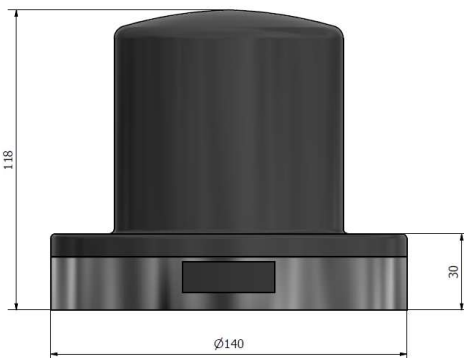
Figure 2. Dimensions physiques de l'antenne Xbeam™ LTE EX (dimensions approximatives en mm).
