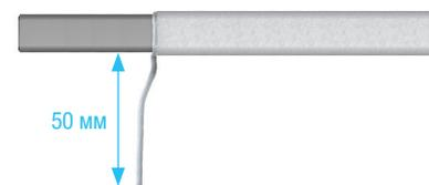
Снимите 40 мм внутренней изоляции и матрицы, так чтобы питающие провода оказались без покрытия. Затем отрежьте по 30 мм от обоих питающих проводов и скрутите их.
