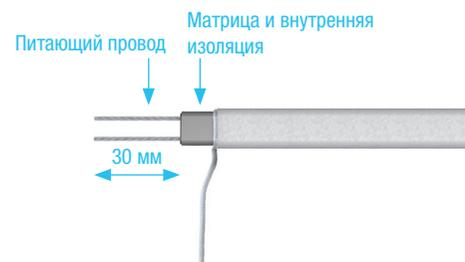
Одновременно введите оба провода питания в изолирующие «штаны». Используйте две трубки для ввода, которые потребуются только для этого шага (с их помощью гибкие литцы протягиваются через изолирующие «штаны»). После успешного ввода две трубки для ввода вытягиваются по направлению конца литцы.
