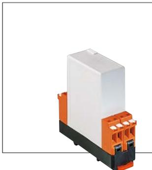
Dieser Optokoppler sorgt für eine sichere galvanische Trennung zwischen einem nichteigensicheren Eingangstromkreis (Sender) und dem in einen eigensicheren Stromkreis geschalteten Ausgang (Empfänger). Dieser ist durch hellblaue Anschluss-klemmen eindeutig gekennzeichnet. Die beiden Kanäle sind untereinander ebenfalls sicher galvanisch getrennt.
