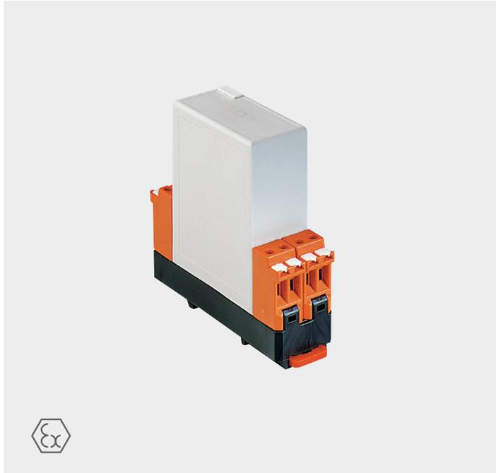
Relais-Bausteine bieten modernen Schaltungskomfort. Eine Schutzbeschaltung der Spule mit einer Diode schützt den Stromkreis vor Spannungsspitzen. Das Relais dient zum Schalten von Stromkreisen bis 6 A und kann durch die geringe Leistungsaufnahme mit elektronischen Schaltkreisen, über Optorelais von BARTEC oder normalen Steuerstromkreisen, angesteuert werden.
