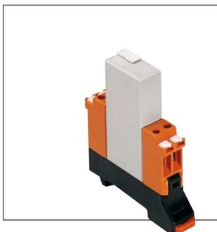
Die Freilaufdiode wird eingesetzt zur Entstörung oder Schutzbeschaltung von Stromkreisen. Wie eine Reihenklemme kann dieses Modul in Reihe oder parallel zu einem Stromkreis installiert werden. Zwei Anschlussklemmen je Seite ermöglichen die Verdrahtung zu anderen MODEX-Modulen oder den direkten Anschluss.
