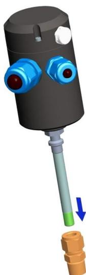
1. Montieren Sie die Überwurfmutter mit dem hinteren und vorderen Klemmring auf dem Anschlusssteil. Achten Sie darauf, dass beide Klemmringe lagerichtig montiert sind.
